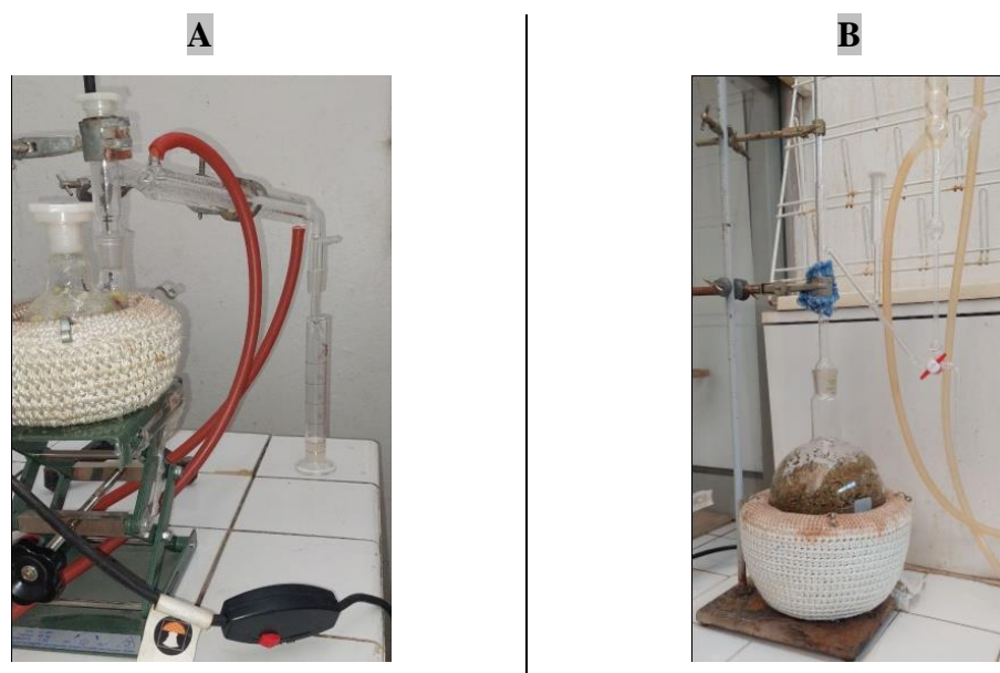
Figure 13. Extraction des huiles essentielles ; hydro-distillateur (A) et clevenger (B).
