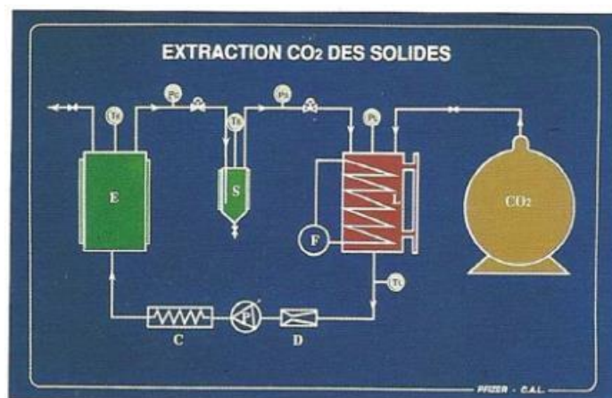
Figure 9. Schéma du montage d'extraction au CO 2 (Beneteaud, 2011).
