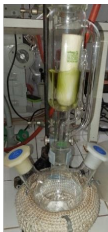
Figure 14. Extraction par soxhelet.
